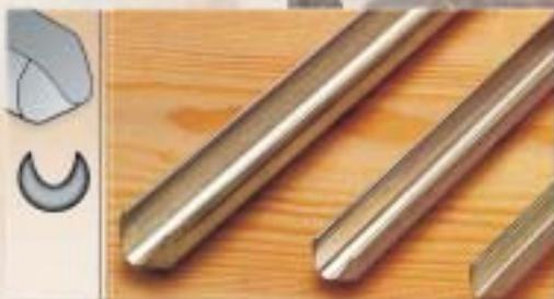
Besonders im Bereich des Querholzdrechsels wird das Werkzeug außergewöhnlich belastet. Hier ist die HSS-Spezial-Schüsseldrehröhre den herkömmlichen Röhren weit überlegen. Die besondere Form dieses Werkzeuges erlaubt eine rasche und starke Spanabnahme bei absoluter Sicherheit gegen Abfangen des Werkzeuges während des Drechsels und sorgt für eine saubere Oberfläche.
