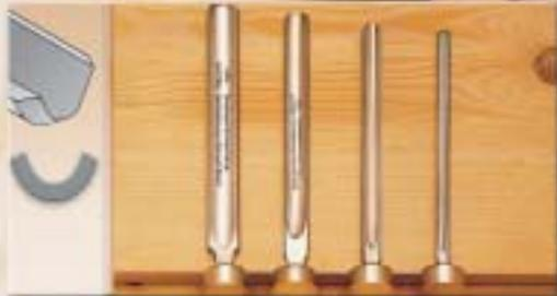
Nahezu alle geschweiften Formen werden mit diesem Werkzeug vorgedreht und soweit wie möglich sauber geschlichtet.
